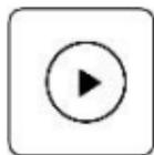
**画面静止按键：** 此功能可快速冻结画面，防止画面抖动从而提高测量的精度，点击此图标后图标将变成静止图标，再次点击静止后仪器重新回到实时拍摄状态。
