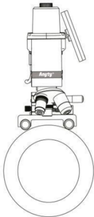
2) 将设备放置在被测物上，旋转镜头保证镜头内打出的光线位于被测物表面。
